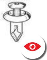
Rivetto con perno per paraurti e rivestimenti su Mitsubishi, lungh. tot. 15 mm, Ø testa 15 mm per foro da 6 mm. Conf da 25 pz.
