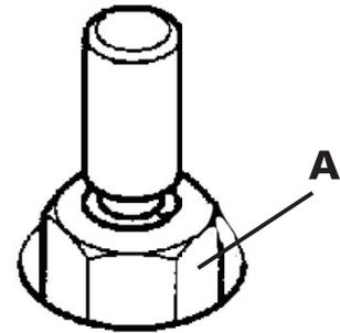
Rimuovere i due tappi di chiusura dal corpo albero a camme e spingere il perno centrale dell'utensile albero a camme nell'alloggiamento di allineamento dell'albero a camme **(B)**. Fissare in sede con il volantino filettato. Può essere necessario rimuovere gli utensili e girare l'albero motore di un giro fino ad innestare correttamente gli utensili.
